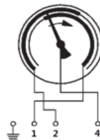
1 : make contact 2 : break contact
