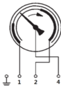
1 : break contact 2 : make contact
