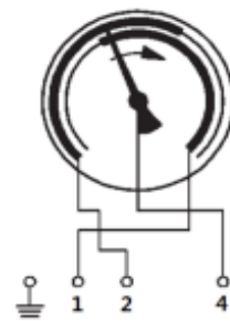
1 : make contact 2 : break contact
