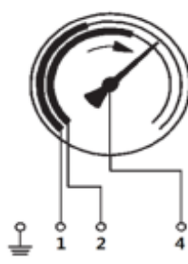
1 : break contact 2 : break contact
