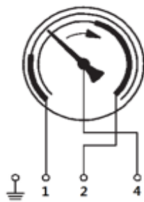
1 : break contact 2 : make contact
